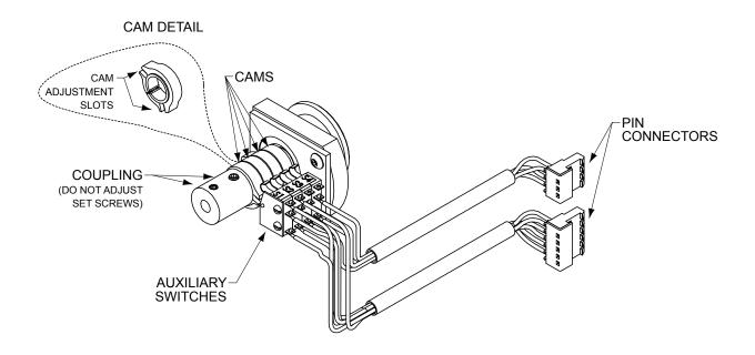
**CONTROL END / CONTACTLESS POSITION SENSOR**
